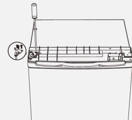
18. Abdeckplatte auflegen und hinten mit den beiden Schrauben befestigen.
