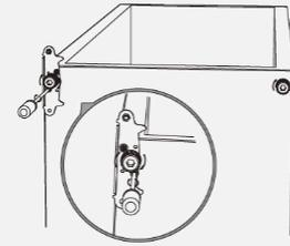
14. Stift des oberen Scharniers in die obere Vorrichtung der Gerätetür einsetzen.
