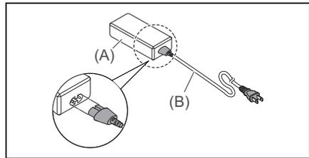
3. Stecken Sie das Kabel (B) in den Anschluss des Netzadapters (A).
