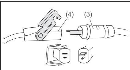
1. Stecken Sie den Stecker (3) in die Buchse (4). Durch die Form der Kontakte ist ein Verpolen nicht möglich.
