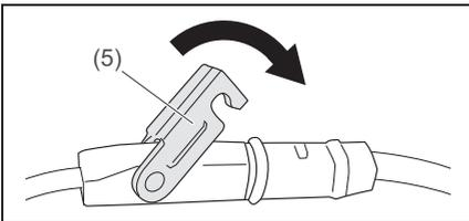
2. Klappen Sie den Riegel (5) herunter, um die Steckverbindung sicher zu verriegeln.
