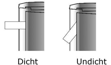
Die Gerätetürdichtung ist undicht, wenn sich das Papier leicht herausziehen lässt.
