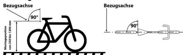
**Achtung:** Überprüfen Sie regelmäßig die richtige Einstellung und Anbauhöhe Ihres Rücklichtes. Das Rücklicht muss in einem Bereich von 250 bis 1200 mm über der Fahrbahn montiert werden. Es muss so angebaut und eingestellt werden, dass die Bezugsachse parallel zur Fahrzeuglängsmittalebene und parallel zur Fahrbahn liegt (siehe Abbildung).
