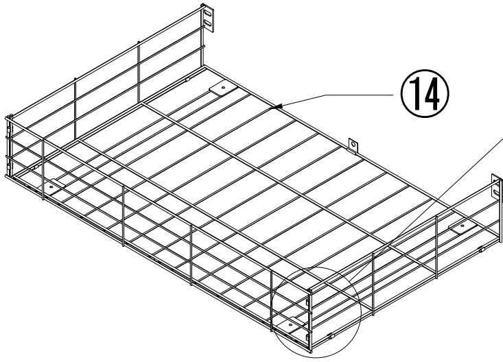
Betten Sie H in die Stange ein und stellen Sie sicher, dass es in ein Loch gewickelt ist, und Installieren Sie 4 Gruppen.
