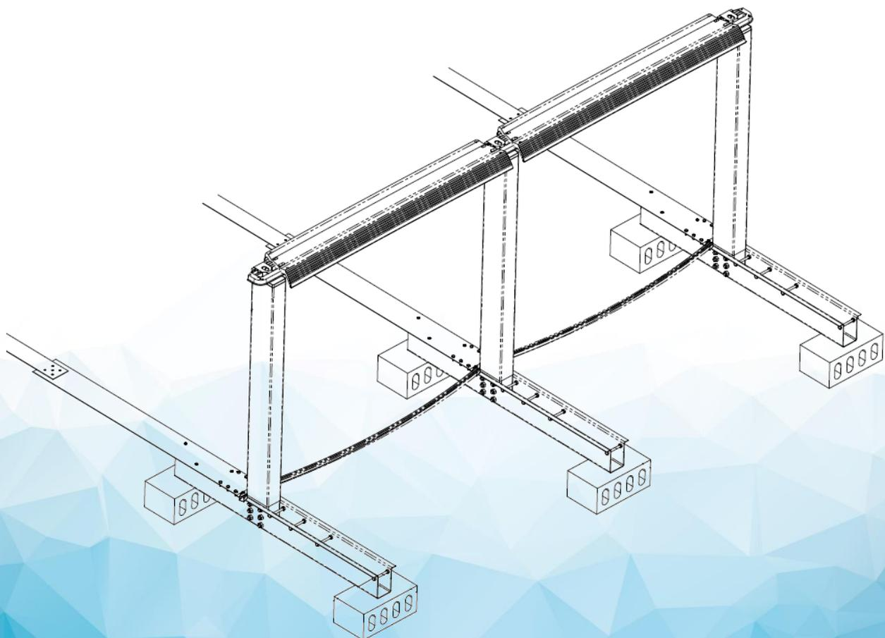
**Überprüfen Sie genau den Abstand zwischen allen Stützpfeosten (Maß S im Kapitel 7.1) und deren senkrechte Ausrichtung. Es muss ebenfalls überprüft werden, dass es zwischen den einzelnen Pfeosten keine Höhenunterschiede gibt.**
