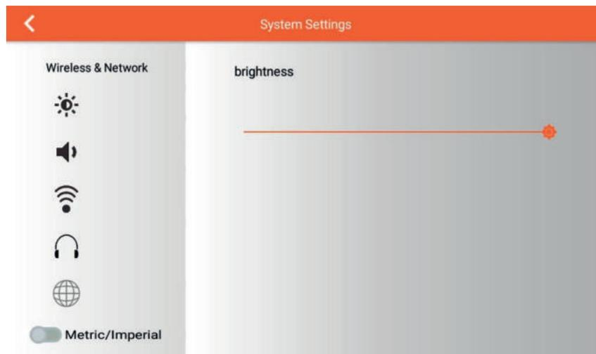
Durch Schieben des Reglers von links nach rechts oder rechts nach links können Sie die Helligkeit des Displays anpassen.
