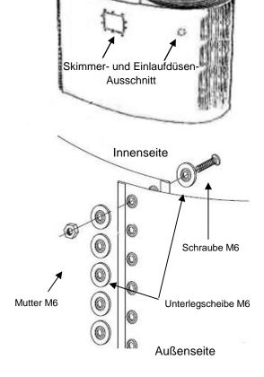
Befestigen Sie die Halterungen der Stützpfostenabdeckungen vor der Montage. Schrauben Sie die Pfosten im unteren Bereich mit 2 Schrauben an ihrem Verbindungsstück fest und befestigen Sie dann die Pfosten im oberen Bereich mit 2 Schrauben an ihrem Verbindungsstück, wobei die beiden Schrauben noch nicht angezogen werden dürfen.
