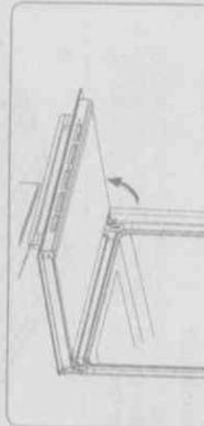
2. Den Sicherheitsbügel a mit einem Schraubendreher bis zum Anschlag öffnen.
