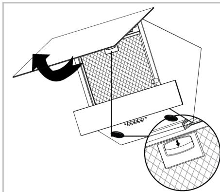
2. Trek het filter zachtjes naar u toe en trek het dan omhoog om het uit de sleuf te verwijderen.
