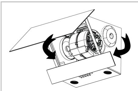
4. Sluit de glazen deksel van de afzuigkap nadat u de aluminium filters hebt geïnstalleerd.
