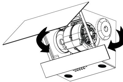
4. Schließen Sie die Glasabdeckung der Dunstabzugshaube nach dem Einbau des Aluminiumfilters.
