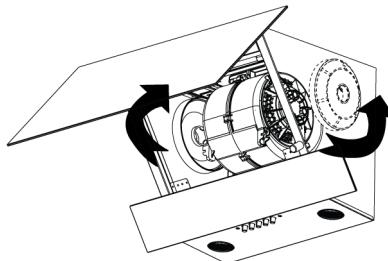
3. Așezați locașurile pentru urechiușe ale noilor filtre de carbon în urechiușele de pe suportul motorului și rotiți-le în sensul acelor de ceasornic pentru a le fixa în poziție.
