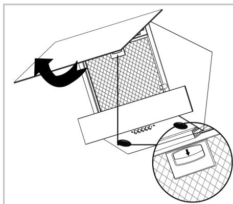
2. Mai întâi trageți foarte ușor filtrul spre dumneavoastră și trageți-l în sus pentru a-l scoate din locaș.
