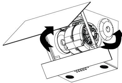
3. Setzen Sie die Nasenschlitze Ihrer neuen Kohlefilter in die Nasen am Motorhalter ein und drehen Sie sie im Uhrzeigersinn, um sie einzurasten.
