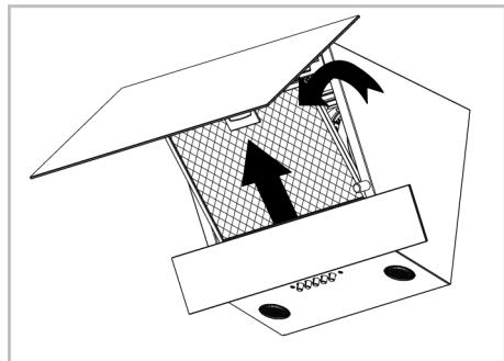
3. Setzen Sie den Aluminiumfilter nach dem Spülen wieder in seinen Schlitz ein, indem Sie die obigen Schritte in umgekehrter Reihenfolge ausführen.
