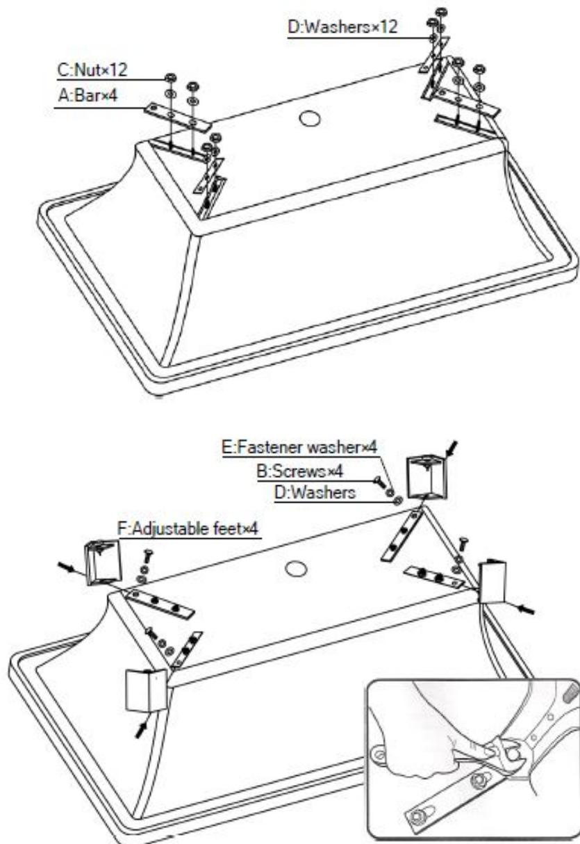
6. Achtung: Stellen Sie die Wanne mit Hilfe der höhenverstellbaren Füße waagrecht auf und überprüfen Sie dies mit einer Wasserwaage. Ziehen Sie nun die Kontermuttern der Stellschrauben fest an. Achten Sie darauf, dass alle Füße auf dem Boden stehen.
