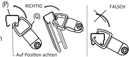
Das U-Profil wird um 8 cm kürzer als die vordere Stange ausgeliefert. Somit muss das U-Profil auf jeder Seite 4 cm eingerückt werden. Achten Sie VOR der Montage des U-Storeschienenhalters (Q) auf die genaue Position am U-Profil (P), da der Halter im Nachhinein nur sehr schwer verschoben werden kann.
