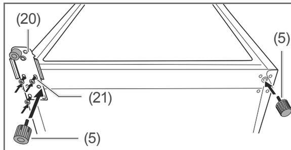
7. Befestigen Sie das untere Scharnier (20) an der linken Seite mit den Schrauben (21).
