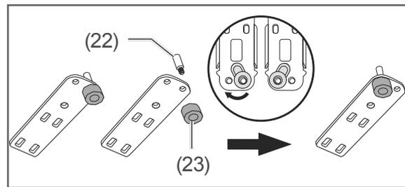
4. Lösen Sie den Scharnierbolzen (22) und den Stützfuß (23) vom unteren Scharnier.
