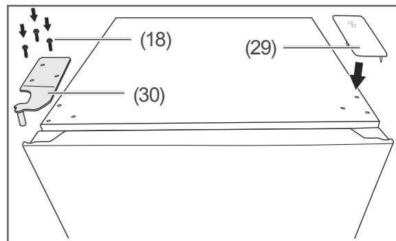
1. Schrauben Sie das obere Scharnier (30) mit den Schrauben (18) fest.
