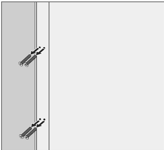
1. Schrauben Sie die vier Schrauben aus der Seite der Gerätetür (3).
