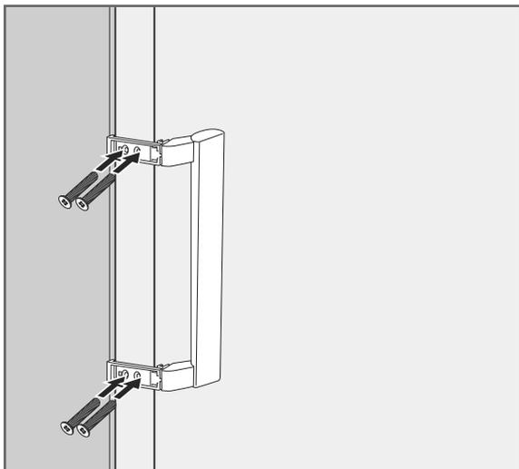
2. Befestigen Sie den Türgriff mit den vier Schrauben an der Gerätetür.
