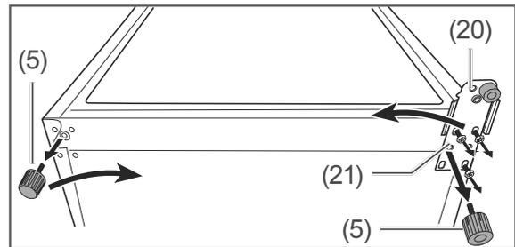
2. Lösen Sie die Schrauben (21) am unteren Scharnier (20).
