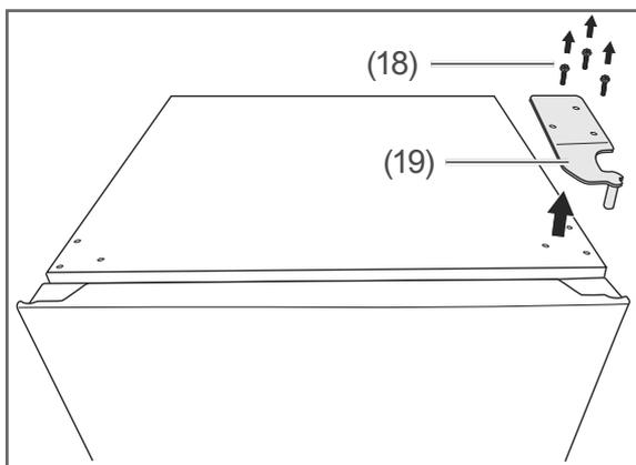
2. Lösen Sie mit dem Kreuzschlitz-Schraubendreher oder dem 8er Schraubenschlüssel die Schrauben (18), und nehmen Sie das obere Scharnier (19) ab.
