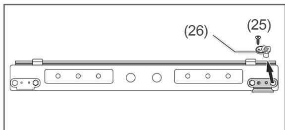
1. Lösen Sie die Schraube (25) und nehmen Sie den Kunststoffeinsatz (26) ab.
