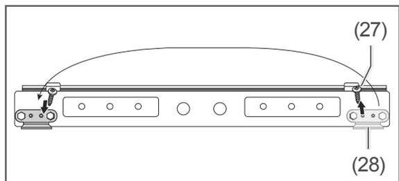
2. Lösen Sie die Schraube (27) und nehmen Sie die Türbefestigung (28) ab.
