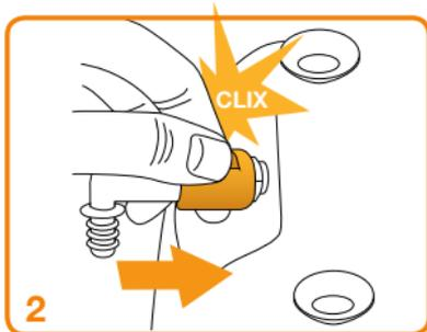
Sicherungsschieber auf **OFF** stellen, Anschluss auf Zulaufstutzen des NU<sup>®</sup> stecken und anschließend den Schieber in die Stellung **ON** bewegen, um somit die Verriegelung zu aktivieren.
