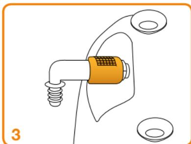
Ein „clix“ signalisiert Ihnen den sicheren Anschluss.
