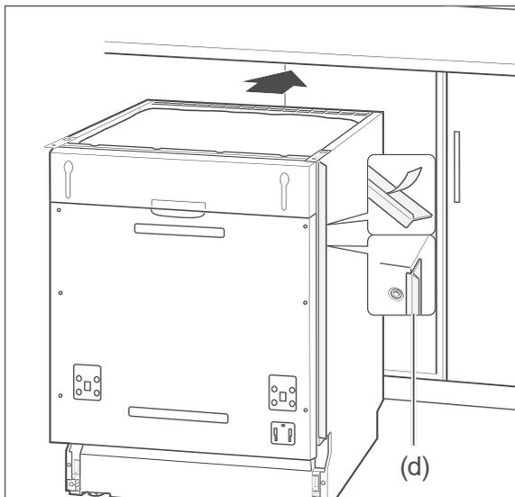
5. Entfernen Sie die Schutzfolien von den seitlichen Abschlussprofilen (d).
