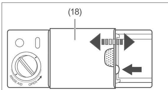
1. Schieben Sie den blauen Verschluss der Kammer für Geschirrspülmittel/Multitabs (18) zur Seite. Der Deckel fährt zur Seite und die Kammer wird sichtbar.
