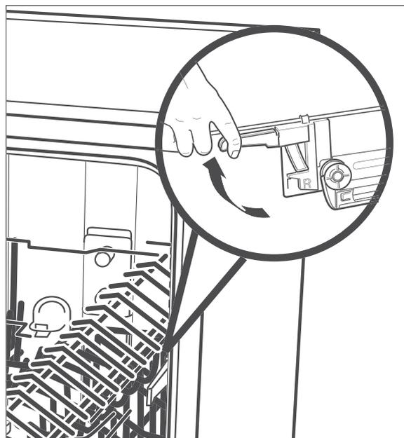
Wenn sich größere Geschirrtteile im unteren Geschirrkorb befinden, können diese den oberen Sprüharm behindern. Setzen Sie den oberen Geschirrkorb nach oben, um dies zu verhindern.
