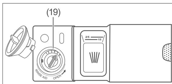
1. Drehen Sie den Deckel der Klarspülmittelkammer (19) eine Viertelumdrehung gegen den Uhrzeigersinn und nehmen Sie ihn heraus.
