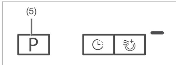
2. Halten Sie die Taste **P** (5) so lange gedrückt, bis das Display nur den aktuellen Härtegrad anzeigt.
