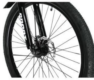
Abbildung 12. Einsatz des Vorderrades bei Scheibenbremsen
