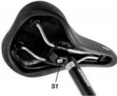
Die Patentstütze hat einen eigenen „integrierten“ Kloben, in dem der Sattel mittels Schraube S1 befestigt wird. Zum Anziehen benötigt man einen 6-mm Inbusschlüssel. Vor dem Anziehen der Schraube S1 kann man die Neigung des Sattels einstellen.
