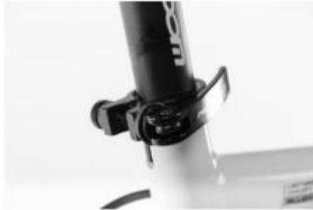
Abbildung 9. Sattelklemme mit Schnellspanner
