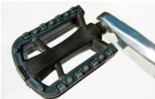
Abbildung 14. Richtige Pedalmontage bis zum Tretkurbelansatz
