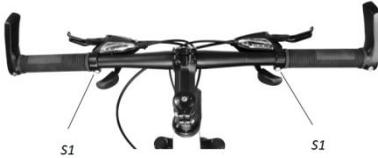
Abbildung 17. Einstellschraube für Zugspannung
