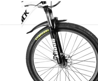
Drehen Sie zunächst die Gabel so um, dass die Vorderbremse zur Fahrtrichtung zeigt (siehe Abbildung links).
