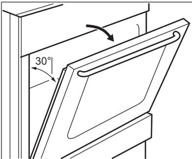
2. Fassen Sie die Türabdeckung (B) an der Oberkante der Tür an beiden Seiten an. Drücken Sie sie nach innen, um den Schnappverschluss zu lösen.
