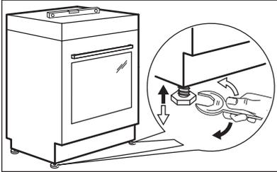
Richten Sie das Gerät mit den unten angebrachten Schraubfüßen so aus, dass sich die Oberfläche des Geräts auf einer Ebene mit den angrenzenden Oberflächen befindet.
