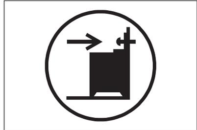
1. Installieren Sie den Kippschutz B – 343 mm unterhalb der Oberseite des Geräts und A – 67 mm von der Seite des Geräts im kreisförmigen Loch in einer Halterung. Verschrauben Sie ihn in festem Material oder benutzen Sie eine geeignete Verstärkung (Wand).
