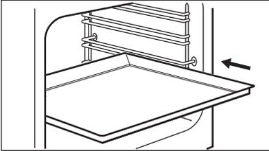
Schiebe das Backblech oder die Auflauffanne zwischen die Führungsschienen der Einhängegitter. Stellen Sie sicher, dass es die Rückwand des Backofens nicht berührt.
