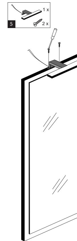
Montieren Sie die Aufbauleuchte mittig auf das Paneel!
