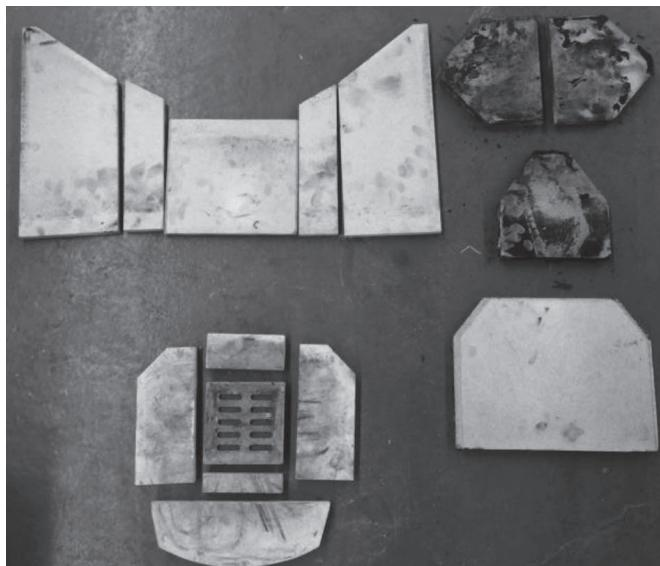
Das Wiedereinsetzen der entnommenen Teile nach ihrer Reinigung erfolgt in umgekehrter Reihenfolge.
