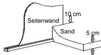
Decken Sie den vorbereiteten Boden mit einem Schutzvlies ab, der 10 bis 12 cm über die Wand hinaus übersteht. Kleben Sie die Schutzfolie an mehreren Stellen mit einem doppelseitigen Klebeband an der Wand an. Der Schutzvlies verhindert das Auftreten von Pilzen unter der Poolfolie
