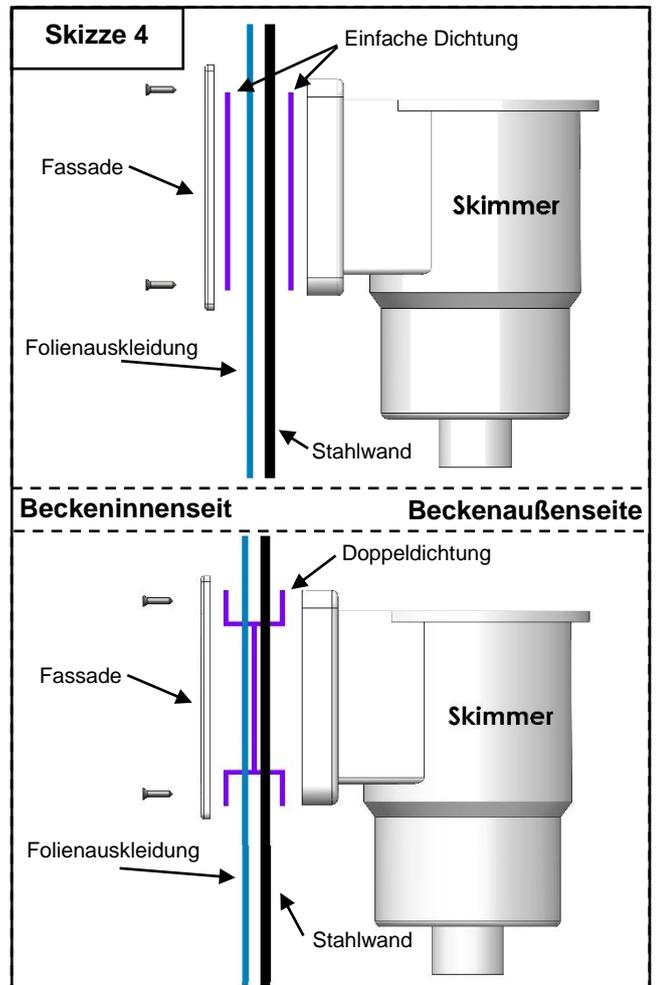
**ACHTUNG:** Ziehen Sie die Schrauben des Skimmers und der Einlaufdüse niemals fest, bevor sich nicht der Wasserstand einige Zentimeter unterhalb des zu montierenden Teils befindet. Die Poolfolie muss durch den Wasserdruck gut gespannt sein.
