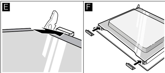
7. Abdeckung aufsetzen und anschrauben.
