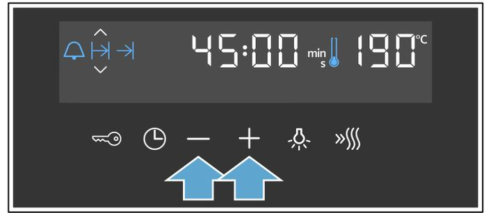
Nach wenigen Sekunden beginnt das Gerät zu heizen. Im Display läuft die Dauer ab.
