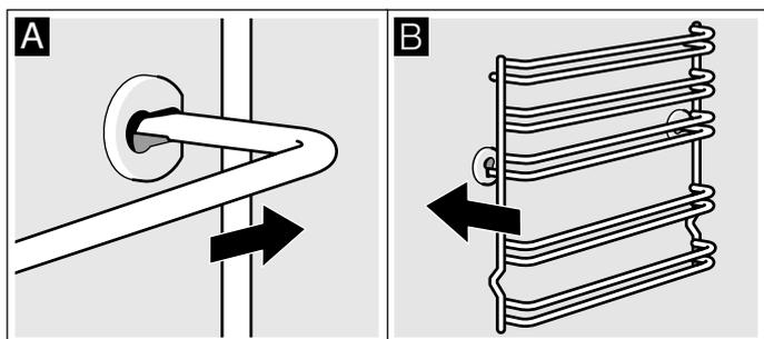
Die Gestelle passen rechts und links. Achten Sie darauf, dass wie in Bild B Höhe 1 und 2 unten ist und Höhe 3, 4 und 5 oben.
