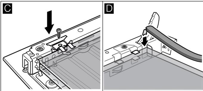
5. Oberste Scheibe schräg nach hinten in die beiden Halterungen einschieben. Achten Sie darauf, dass Sie dabei die Dichtung nicht nach hinten schieben (Bild E).
