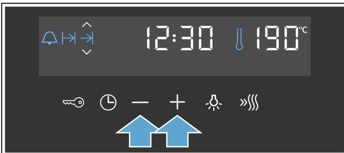
Nach wenigen Sekunden übernimmt das Gerät die Einstellungen. Im Display steht die Endezeit. Sobald das Gerät startet, läuft die Dauer ab.
