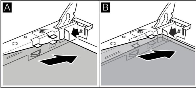
3. Halteklammern rechts und links auf die Scheibe stecken, ausrichten, dass die Federn über dem Schraubloch sind und festschrauben (Bild C).
