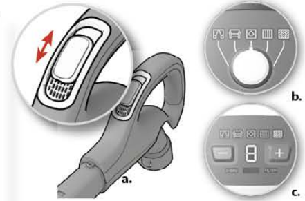
9. لضبط قوة الشفط (على حسب الموديل): a. تم باستخدام زر التحكم الموجود على المقيض.* b. تم باستخدام زر التحكم الموجود على المكسنة.* c. تم باستخدام زر التحكم + أو - الموجود على المكسنة.*
