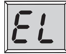
*Hinweis: Wenn Sie nähen und sich der Faden am Haken verfängt, sodass sich die Nadel nicht mehr bewegen lässt, wird die Nähmaschine über den Sicherheitschalter komplett ausgeschaltet, wenn Sie den Fußanlasser weiterhin betätigen. Um die Nähmaschine neu zu starten, müssen Sie die Taste EIN/AUS betätigen, um das Gerät zunächst ein- und dann wieder auszuschalten.*
