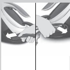
**4** Piegate il tubo flessibile del vapore e il cavo di alimentazione.
