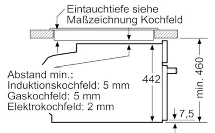
Wird das Kompaktgerät unter einem Kochfeld eingebaut, muss folgende Arbeitsplattenstärke (ggf. inkl. Unterkonstruktion) beachtet werden.
