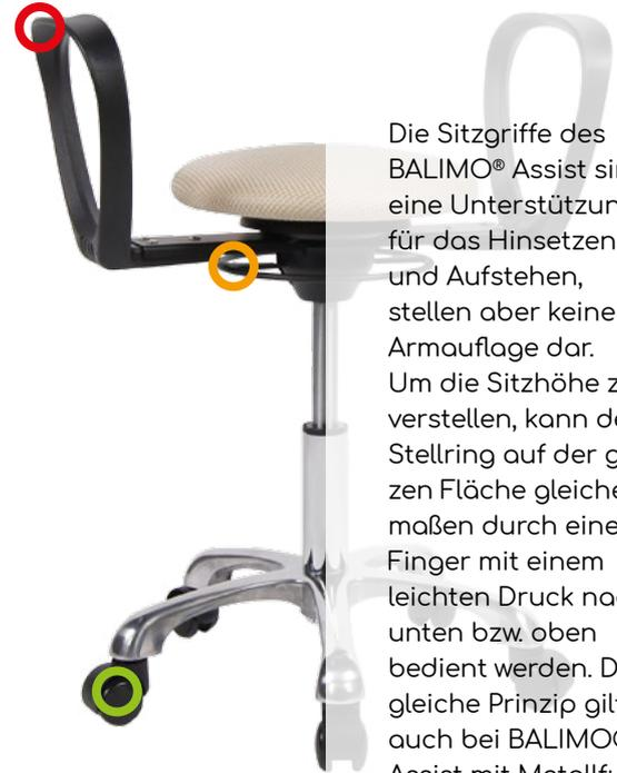
Die Sitzgriffe des BALIMO® Assist sind eine Unterstützung für das Hinsetzen und Aufstehen, stellen aber keine Armauflage dar. Um die Sitzhöhe zu verstellen, kann der Stellring auf der ganzen Fläche gleichermaßen durch einen Finger mit einem leichten Druck nach unten bzw. oben bedient werden. Das gleiche Prinzip gilt auch bei BALIMO® Assist mit Metallfuß. Die Rollen stoppen sicher bei Belastung.
