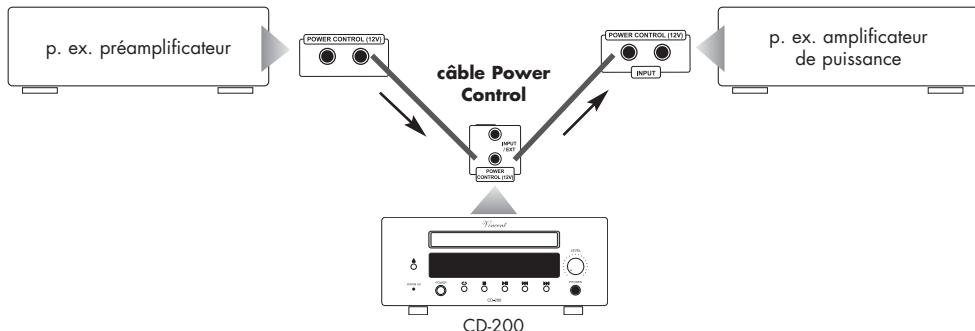
Grâce à un appareil transmetteur, un nombre illimité d'appareils peut être en théorie alimenté avec des impulsions de distribution. Pour ce faire, on pourra utiliser sur la plupart des appareils une des deux prises « POWER CONTROL » comme entrée du signal et l'autre comme sortie du signal. Cette méthode, consistant à mettre en circuit les entrées et les sorties des appareils et de les enchaîner ainsi, est aussi appelée « daisy chaining ».
