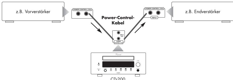
Durch ein sendendes Gerät können theoretisch unendlich viele Geräte mit den Schaltimpulsen versorgt werden. Zu diesem Zweck kann an den meisten Geräten einer der beiden „POWER CONTROL“-Anschlüsse als Signaleingang und der andere als Signalausgang verwendet werden. Diese Methode, das Signal durch Ein- und Ausgänge der Geräte durchzuschleifen und diese somit zu verketten, wird auch als „daisy chaining“ bezeichnet.
