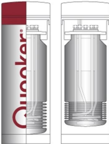
Denn dieses Reservoir hat Platz für Expansionswasser, weil die Kesselwand aus Edelstahl flexibel ist. Ein Teil des Reservoirs ist als **Balg** konzipiert, der sich bei jedem Aufheizen des Wassers etwas ausdehnen kann. Sobald Wasser abgezapft wird, schrumpft der Balg in seine Ausgangsposition zurück und ist wieder bereit, frisches Leitungswasser aufzuheizen.
