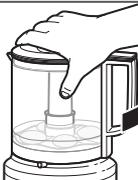
Setzen Sie den Deckel mit dem Deckelgriff nach vorne auf die Arbeitsschüssel. Drehen Sie den Deckelgriff gegen den Uhrzeigersinn, bis er einrastet. Der Deckel klickt, wenn er richtig eingerastet ist.
