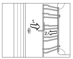
■ Ziehen Sie die Aufnahmegitter vorn aus der Befestigung (1.) und nehmen Sie sie heraus (2.).
