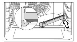
Schieben Sie den FlexiClip-Vollauszug entlang der oberen Strebe schräg nach hinten bis zum Anschlag (3.).
