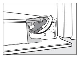
■ Entriegeln Sie die Sperrbügel, indem Sie sie bis zum Anschlag drehen.
