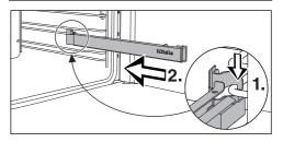
■ Haken Sie den FlexiClip-Vollauszug vorn auf der unteren Strebe einer Ebene ein (1.) und schieben Sie ihn entlang der Strebe in den Garraum (2.).
