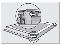
Öffnen Sie die beiden Arretierungen für die Türscheiben durch eine Drehbewegung nach außen. Bauen Sie die Türinnenscheibe aus:
