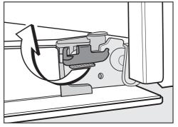
■ Verriegeln Sie die Sperrbügel wieder, indem Sie sie bis zum Anschlag in die Waagerechte drehen.
