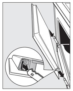
■ Fassen Sie die Tür seitlich an und stecken Sie sie auf die Halterungen der Scharniere.
