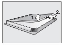
■ Heben Sie die Türinnenscheibe leicht an und ziehen Sie sie aus der Kunststoffleiste heraus.
