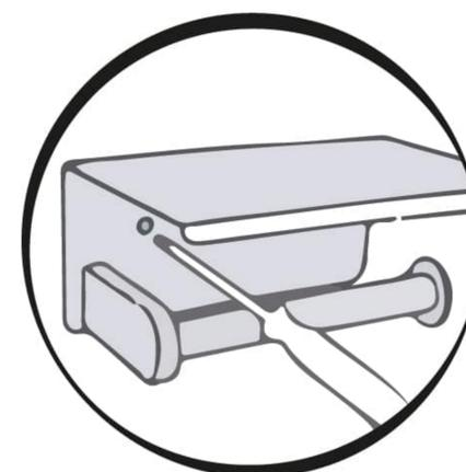
Positionieren Sie den Halter erneut an der Wand und ziehen Sie die Schrauben an den beiden Löchern fest.
