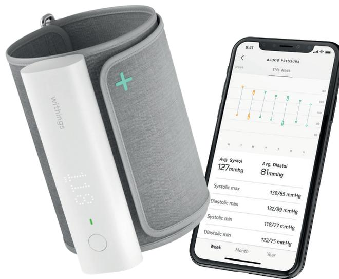
BPM Connect ist ein vernetztes Blutdruckmessgerät, das medizinisch präzise Messdaten des Blutdrucks und der Herzfrequenz ermittelt. Die Messergebnisse werden direkt nach der Messung am Gerät abgebildet und in der App zusammen mit vorangegangenen Messungen als Messdatenverlauf vollständig gespeichert.
