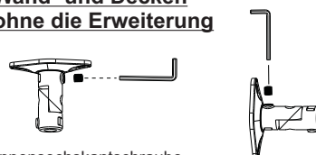
Innensechskantschraube mit dem mitgelieferten Imbus
