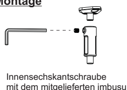
Innensechskantschraube mit dem mitgelieferten Imbus
