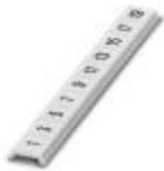
Zackband flach, Streifen, weiß, beschriftet, längs bedruckt: ungerade Zahlen 1-19, 21-39 usw. bis 81-99, Montageart: verrasten in flacher Schildchennut, für Klemmenbreite: 5 mm, Schriftfeldgröße: 5,15 x 5,15 mm, Anzahl der Einzelschilder: 10
