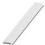
Zackband flach, Streifen, weiß, unbeschriftet, beschriftbar mit: PLOTMARK, CMS-P1-PLOTTER, Montageart: verrasten in flacher Schildchennut, für Klemmenbreite: 5 mm, Schriftfeldgröße: 5,1 x 5,2 mm, Anzahl der Einzelschilder: 10
