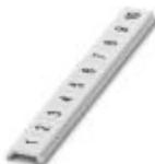
Zackband flach, Streifen, weiß, beschriftet, längs bedruckt: fortlaufende Zahlen 1 ... 10, 11 ... 20 usw. bis 491 ... 500, Montageart: verrasten in flacher Schildchennut, für Klemmenbreite: 5 mm, Schriftfeldgröße: 5,15 x 5,15 mm, Anzahl der Einzelschilder: 10
