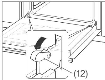
2. Klappen Sie an beiden Seiten die Bügel (12) ganz nach vorne. Nehmen Sie gegebenenfalls einen Schraubendreher zu Hilfe.
