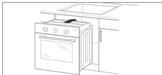
1. Schieben Sie den Backofen in die Einbaunische, bis die Frontblende auf den Rahmen des Einbauschanks trifft.
