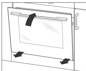
4. Heben Sie die Backofentür leicht an und lassen Sie sie nach vorne herausgleiten.
