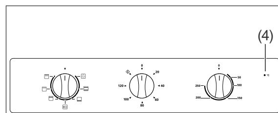
Die rote Temperaturkontrollleuchte (4) leuchtet, sobald Sie eine Beheizungsart gewählt, die Temperatur eingestellt und die Zeitschaltuhr (2) eingestellt haben. Sie leuchtet, solange der Backofen auf- bzw. nachheizt. Wenn sie das erste Mal erlischt, ist die eingestellte Temperatur im Backofen erreicht.
