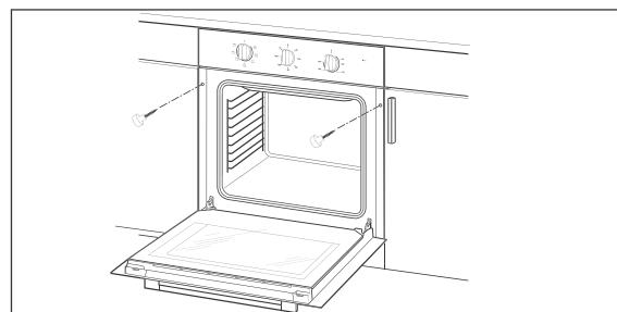
3. Wenn der Backofen richtig ausgerichtet ist, öffnen Sie die Backofentür und schrauben Sie ihn mit den beiliegenden Montageschrauben am Einbauschrank fest.
