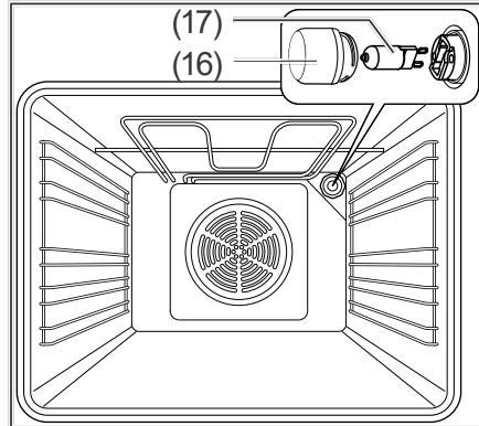
3. Schrauben Sie die Glasabdeckung (16) gegen den Uhrzeigersinn ab, und nehmen Sie sie heraus.
