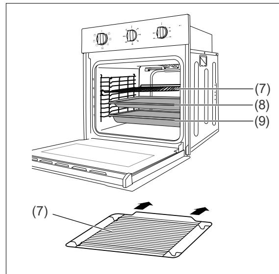
An den Seitenwänden des Garraums befinden sich die Backblechträger (6).
