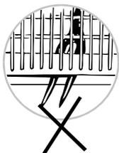
Achten Sie beim Einladen des Bestecks darauf, dass es nicht durch den Boden des Besteckkorbs stößt. Der untere Sprüharm wird sonst blockiert.
