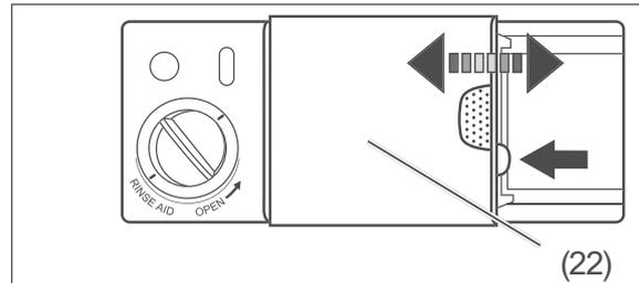
1. Schieben Sie den blauen Verschluss der Kammer für Geschirrspülmittel/Multitabs (22) zur Seite. Der Deckel fährt zur Seite und die Kammer wird sichtbar.
