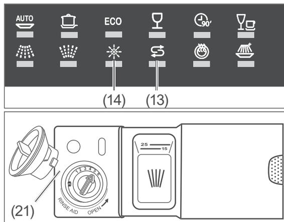
1. Drehen Sie den Deckel der Klarspülerkammer (21) eine Viertelumdrehung gegen den Uhrzeigersinn und nehmen Sie ihn heraus.
