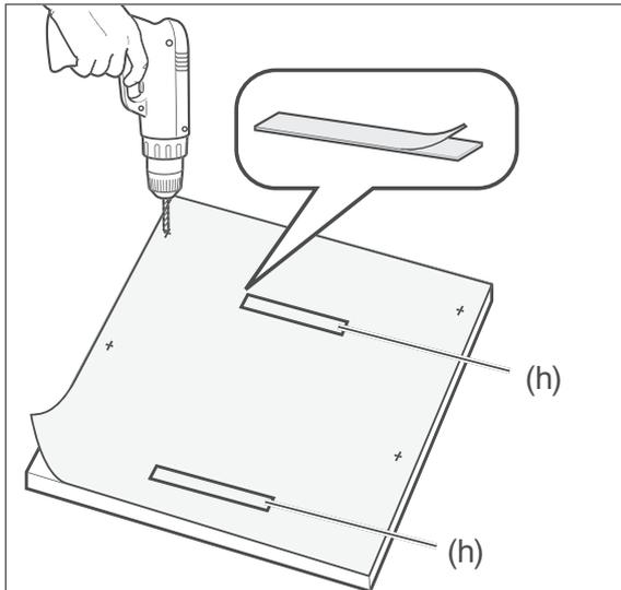
12. Legen Sie die mitgelieferte Bohrerschablone so auf die **Rückseite** der Möbelfrontplatte, dass die Bohrerschablone und die Möbelfrontplatte oben bündig abschließen.
