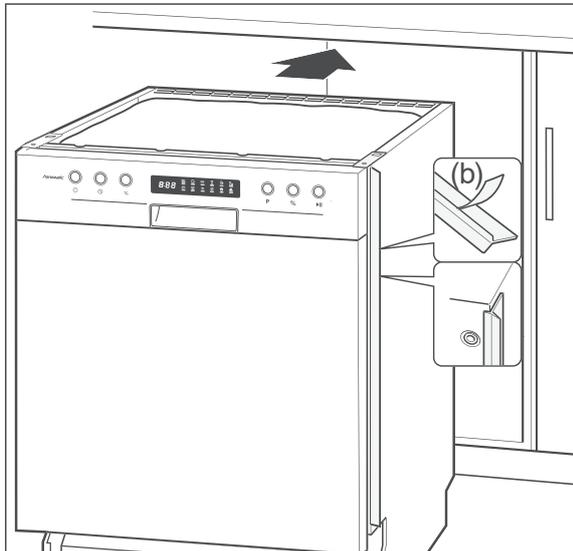
5. Entfernen Sie die Schutzfolien von den seitlichen Abschlussprofilen (b).
