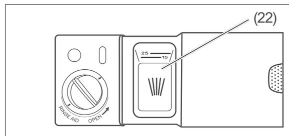
2. Legen Sie einen Multitab in die Kammer. Schieben Sie den Deckel der Kammer zu, sodass der Verschluss wieder einrastet.
