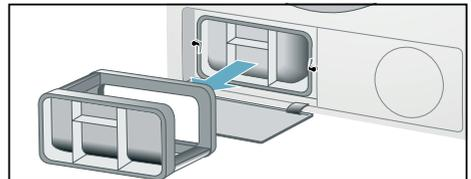
5. Entnehmen Sie den Wärmetauscher.
