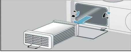
6. Spülen Sie den Wärmetauscher von allen Seiten mit einem Wasserstrahl durch, um alle Flusen vollständig zu entfernen.
