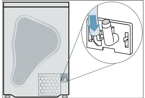
5. Nehmen Sie den Ablaufschlauch aus dem Zubehör und befestigen diesen am leeren Stutzen.
