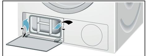
4. Ziehen Sie den Ausatz des Wärmetauschers heraus.
