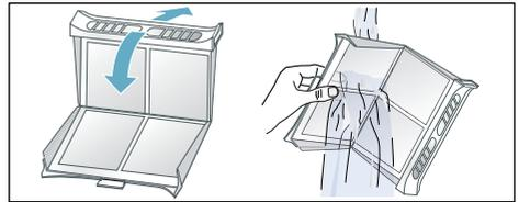
6. Trocknen Sie das Flusensieb ab, klappen dies zu und setzen das Flusensieb wieder ein.
