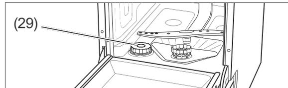
2. Drehen Sie den Deckel der Regeneriersalz-Kammer (29) gegen den Uhrzeigersinn auf und nehmen Sie ihn ab.
