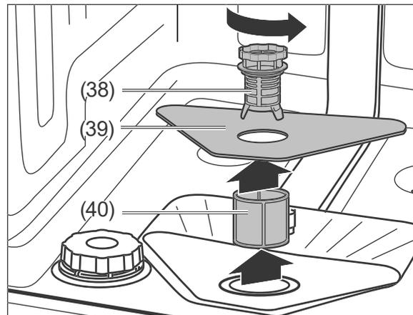
Entfernen Sie regelmäßig die Speisereste aus dem Grobsieb (38), dem Hauptsieb (39) und Feinsieb (40).
