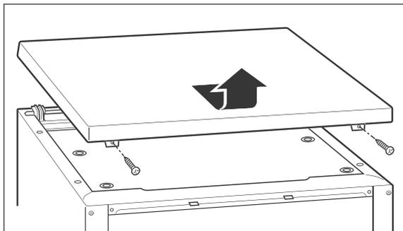
1. Drehen Sie die beiden Schrauben auf der Rückseite der Abdeckplatte heraus.
