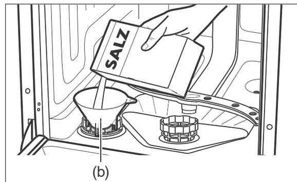
3. Setzen Sie den mitgelieferten Einfülltrichter (b) auf die Kammeröffnung.
