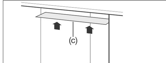
4. Kleben Sie die beiliegende Kondenswasser-Schutzfolie (c) auf die Unterseite der Arbeitsplatte. So vermeiden Sie Schäden an der Arbeitsplatte aufgrund heißer Dämpfe, die bei geöffneter Tür aus dem Geschirrspüler strömen.
