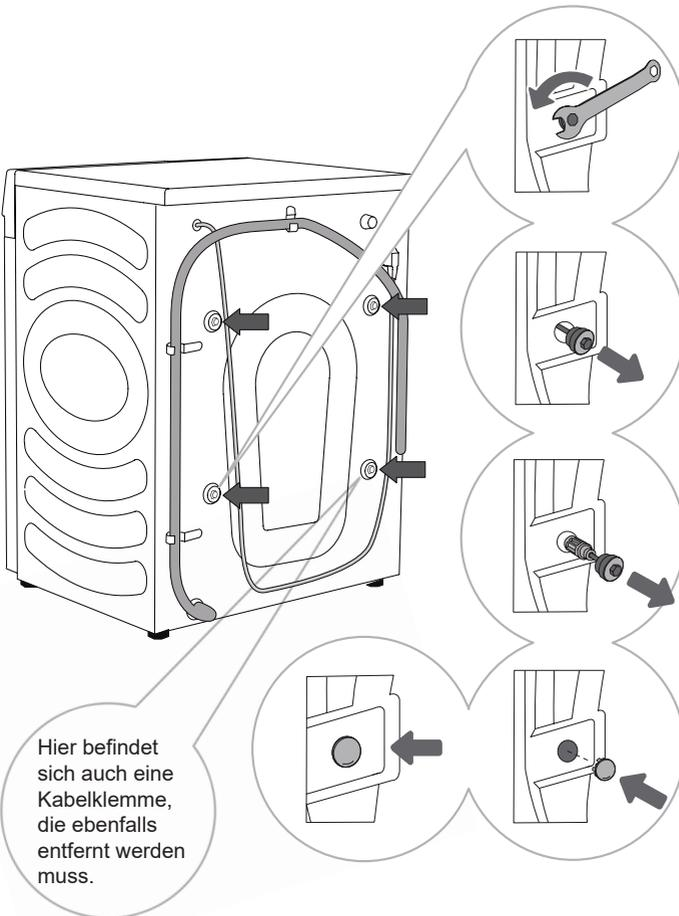
Hier befindet sich auch eine Kabelklemme, die ebenfalls entfernt werden muss.
