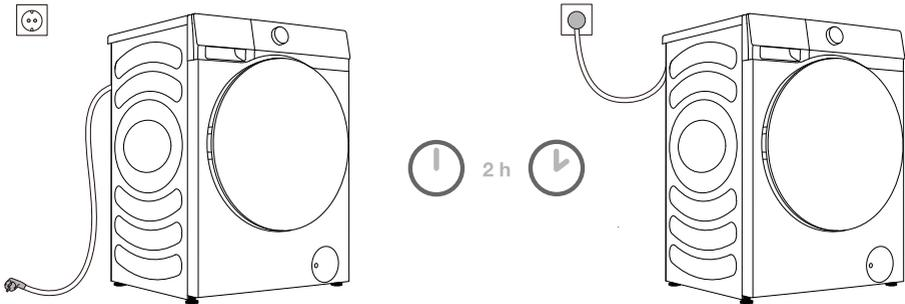
**⚠** **Bevor Sie den Wäschetrockner am Stromnetz anschließen, warten Sie mindestens 2 Stunden, bis die Raumtemperatur erreicht hat.**
