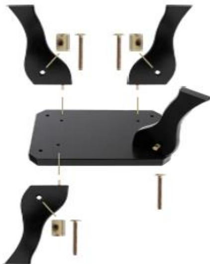
Die Dübel der Beine (K.) müssen in das angebohrte Loch. Die Beine werden durch die Schrauben (H.) befestigt.
