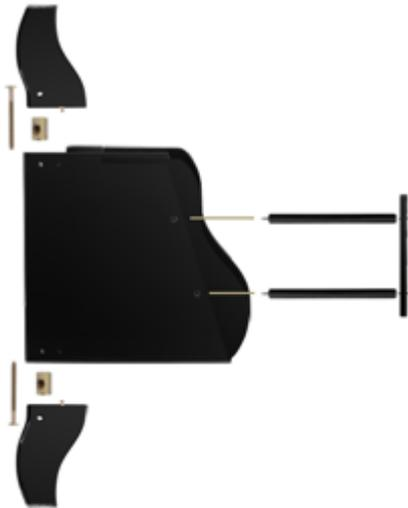
1. Drehen Sie den Flügel auf den Kopf und befestigen Sie die Bauteile (C.) mit den Schrauben (L.). Schrauben Sie Bauteile (D.) in die dafür eingelassenen Innengewinde ein.
