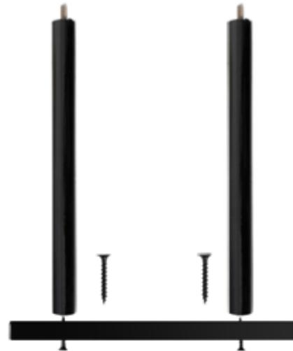
2. Befestigen Sie das Bauteil B. mit den mitgelieferten Holzschrauben Bauteil (G.) **WICHTIG! Achten Sie darauf die Schrauben mittig rein zu schrauben.**
