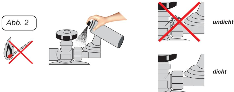
Nach jeder Montage des Druckreglers und immer dann, wenn es erforderlich ist, muss die folgende Dichtheitsprüfung durchgeführt werden:
