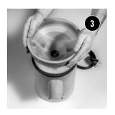
Nehmen Sie nun den Trichter und drehen ihn im Uhrzeigersinn eine Umdrehung zu. Dann stecken Sie den Netzstecker ein, schalten das Gerät an und drehen weiter zu bis ein leichtes Steinschleifgeräusch hörbar ist.
