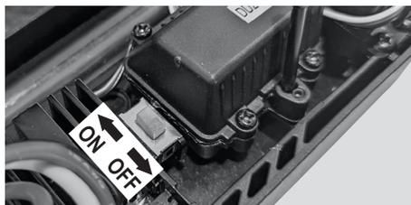
Schließen Sie jetzt den Fahrakku an den Fahrtregler an. Achten Sie dabei auf die richtige Polarität (rotes Kabel = Plus/+, schwarzes Kabel = Minus/-). Wenden Sie beim Verbinden des Akkusteckers mit dem Anschluss des Fahrtreglers keine Kraft an.
