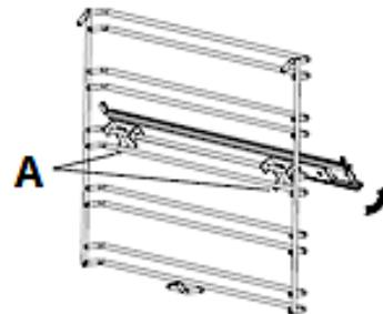
2. Drehen Sie die Teleskopschiene dann leicht gegen den Uhrzeigersinn (s. Abb. rechts, Pfeil).
