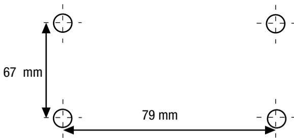
2. Bohren Sie die Löcher an den markierten Stellen in die Wand.
