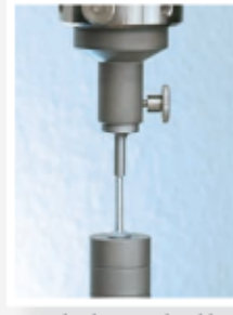
Test Nietdomausdrückkraft Mandrel push out test Essai de retenue de la tête de rivet
