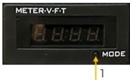
Durch Betätigung der Taste (1) kann zwischen den einzelnen Modi gewechselt werden: / By operating the key (1), you can switch between the individual modes:
