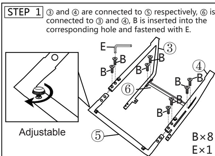
und sind jeweils mit verbunden, ist mit und verbunden. B wird in das entsprechende Loch eingefügt und mit E befestigt.
