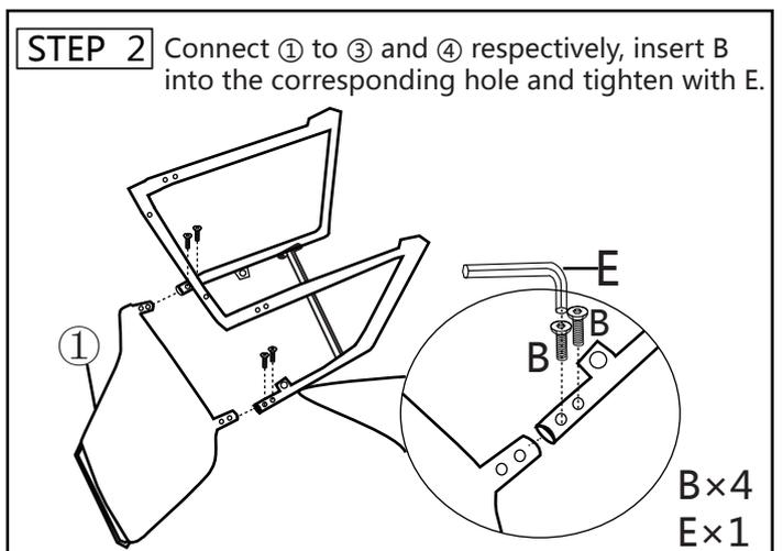
Verbinden Sie jeweils mit und , setzen Sie B in das entsprechende Loch ein und ziehen Sie es mit E fest.
