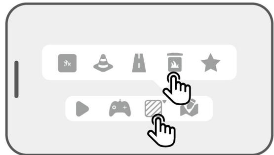
2. Steuern Sie den Roboter in einen Aufgabenbereich oder in die Nähe einer Begrenzung und tippen Sie dann zum Start auf ►.
