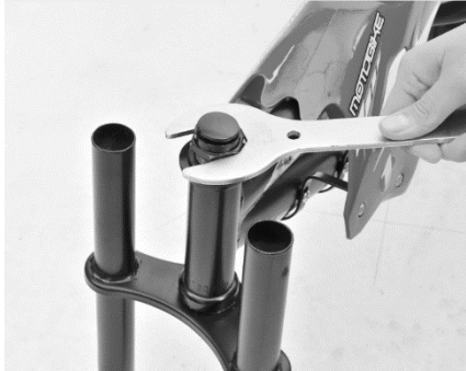
Figura 1: Afloje la tuerca del tubo de dirección
