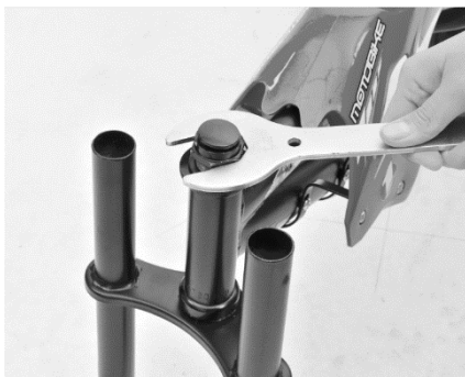
Abbildung 1: Mutter des Lenkerrohrs lösen
