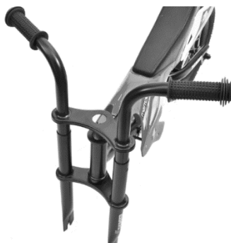
Figura 1: Allineare il manubrio sulla forcella e sul canotto anteriore
