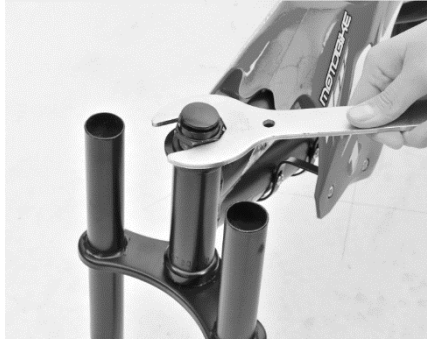
Schéma 1: Retirez l'écrou du tube de direction
