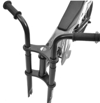
Figura 1: Alinee los manillares sobre la horquilla y el tubo de dirección.
