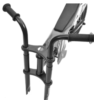
Figuur 1: Breng de stuurstangen boven de vork en de hoofdbuis op één lijn
