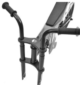
Abbildung 1: Lenkergriffe über der Gabel und dem Lenkerrohr ausrichten
