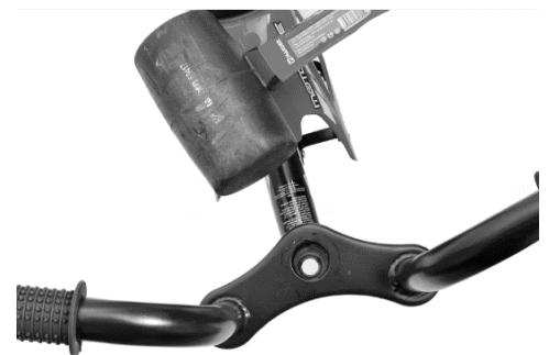
Abbildung 3: Lenker an Gabel und Rahmen ausrichten
