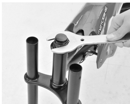
Figuur 1: Draai de moer van de hoofdbuis los
