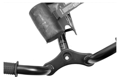
Figuur 3: Breng de stangen op de vork en het frame op één lijn.
