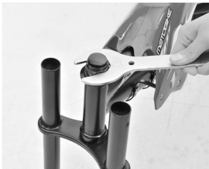
Figura 1: Rilasciare il dado del canotto anteriore
