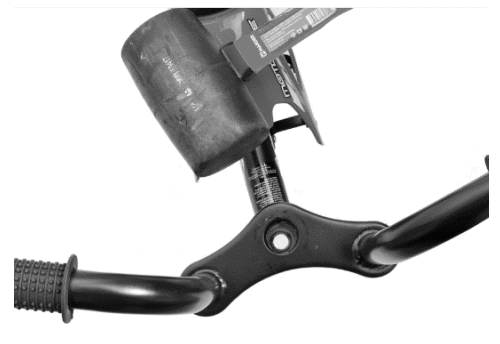
Figura 3: Allineare il manubrio sulla forcella e sul telaio.
