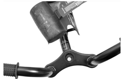
Schéma 3: Alignez les poignées sur la fourche et le cadre
