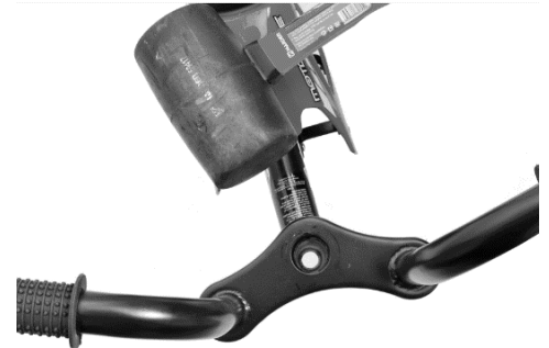
Figura 3: Alinee las barras en la horquilla y el cuadro.
