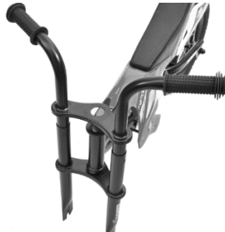
Schéma 1: Insérez les poignées au-dessus de la fourche et du tube de direction
